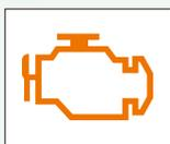
エンジン回転中にエンジン電子制御システムや排気ガス関連装置に異常があるときに点灯します。
