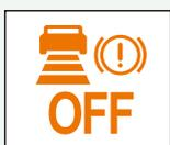
衝突被害軽減ブレーキのシステム故障により衝突被害軽減ブレーキを停止した場合に点灯します。
