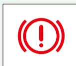
エンジン回転中(始動後)、ブレーキフルードの減少や充電システムに異常が生じたときに点灯します。
