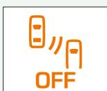
後側方接近車両注意喚起装置に異常があるときに点灯します。
