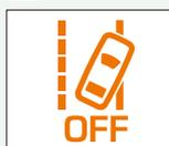
車線逸脱警報に異常があるときや車線逸脱警報の機能を停止させたときに点灯します。
